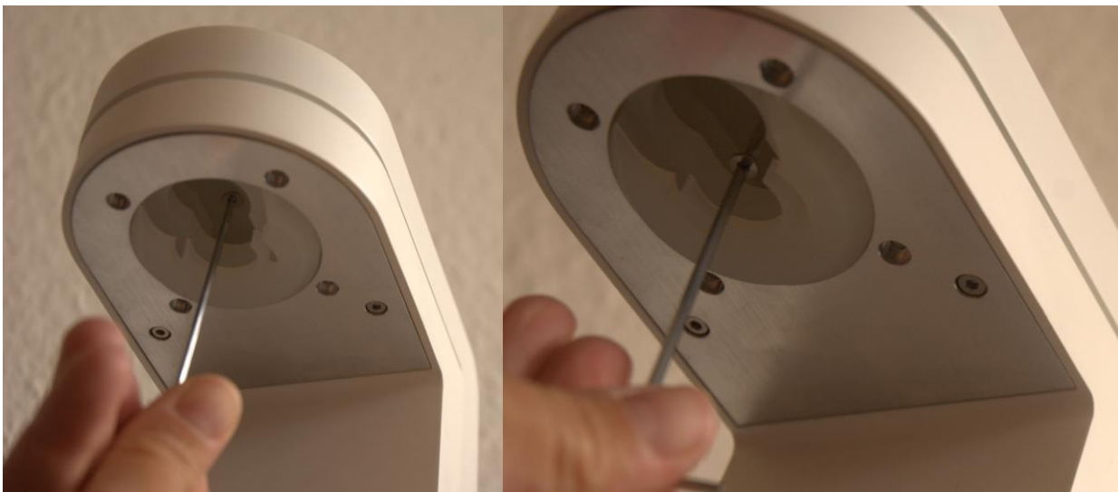
Abbildung 19 - Herausdrehen der Schrauben des Adapteroberteils
