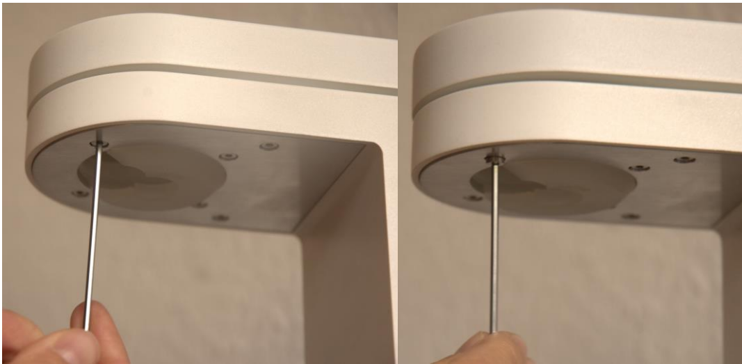
Abbildung 18 - Herausdrehen der Schrauben des Adapterunterteils
